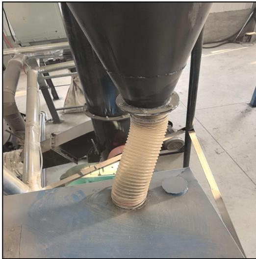
灌装机与旋风下料口密闭连接
